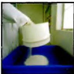
Foto 23. Tamizado de la pre-mezcla concentrada.
