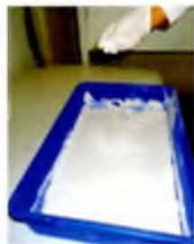
Foto 21. Comprobación de secado de la pre-mezcla concentrada.
