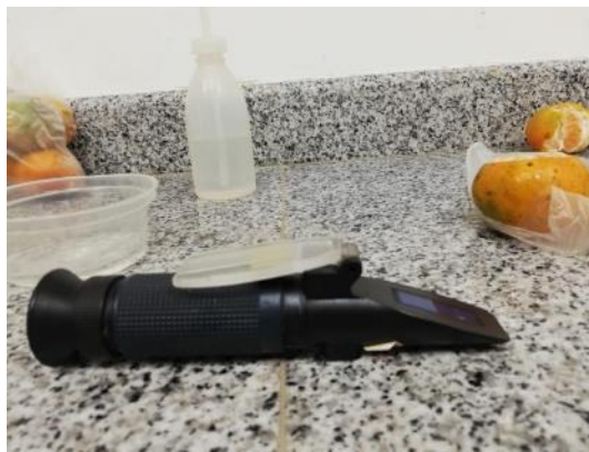
Figura 5. Refractómetro utilizado para la obtención del valor de °Brix
