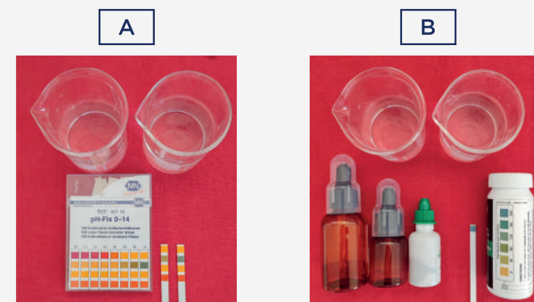
Figura 2. Lectura de pH con tiras (A) y dureza por colorimetría y tiras (B) en muestras de agua. Fuente: INIAP.
