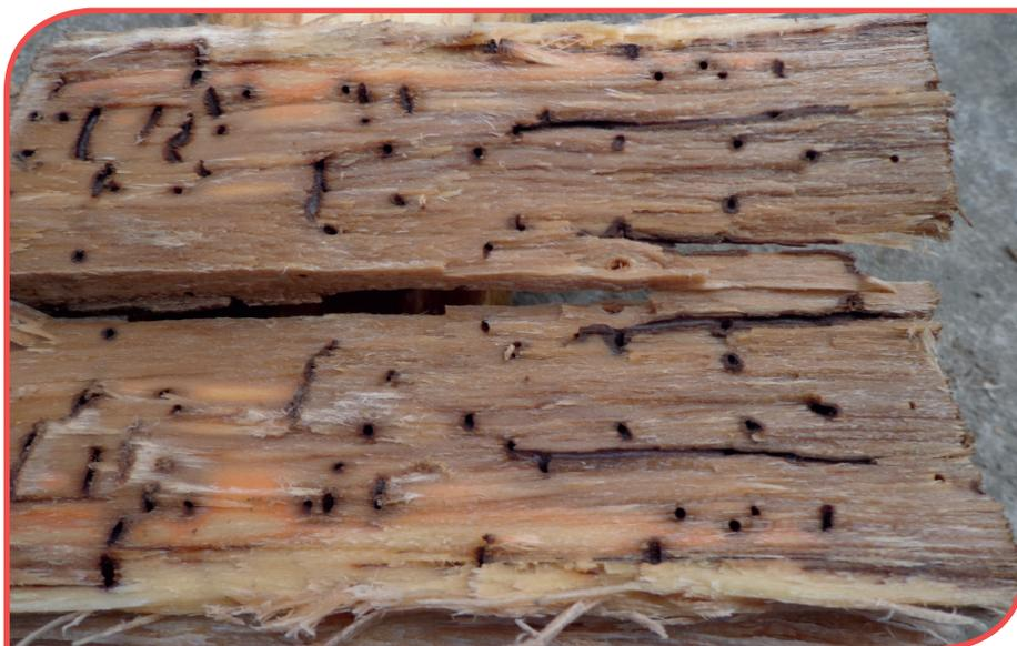
**Figura 22.** Gran cantidad de galerías originadas de una sola perforación observada en el fuste de un árbol de teca.
