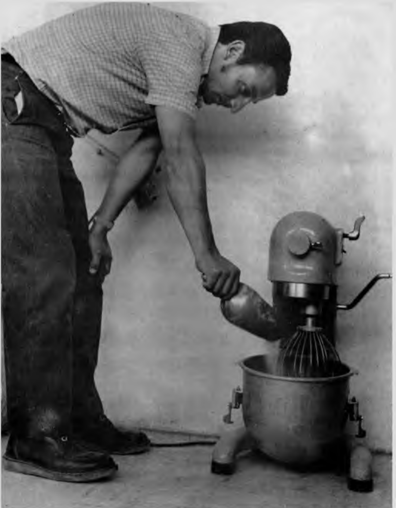
USO DE LA PREMEZCLADORA.— Las vitaminas, minerales y antibióticos que conforman las premezclas, es conveniente homogenizarlas en una premezcladora, para luego incorporarlas a los demás ingredientes de las dietas.
