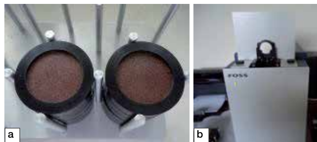
Foto 37. Lectura espectrométrica de infrarrojo cercano (NIRS) de muestras de cacao en polvo (a), utilizando un espectrofotómetro Foss 6500 (b).
