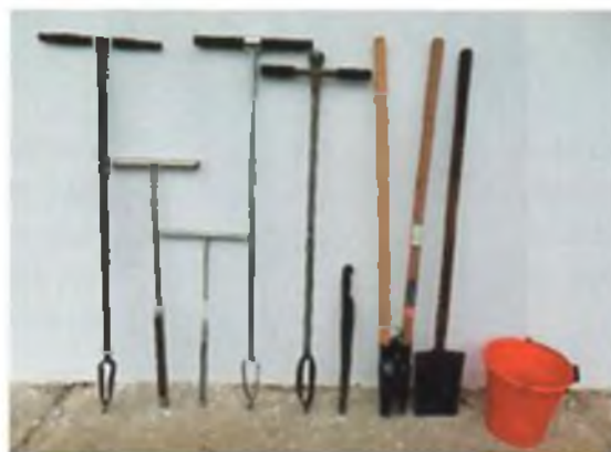
Fig. 50. Barrenos y otras herramientas utilizadas para muestrear suelos.
