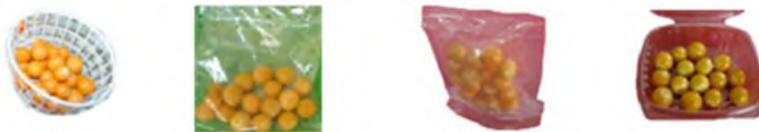
Figura 26. Empaques evaluados para la conservación de uchuva (canastillas cubiertas con vinipel, PP, poliamida y cajas PET).
