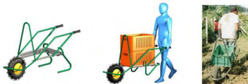
Figura 10. Carretilla para la recolección y transporte de la uchuva.
