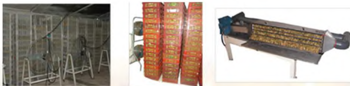
Figura 17. Tipos de deshidratación del cáliz con aire a temperatura ambiente, ventilación natural, aire caliente y ventilación forzada.
