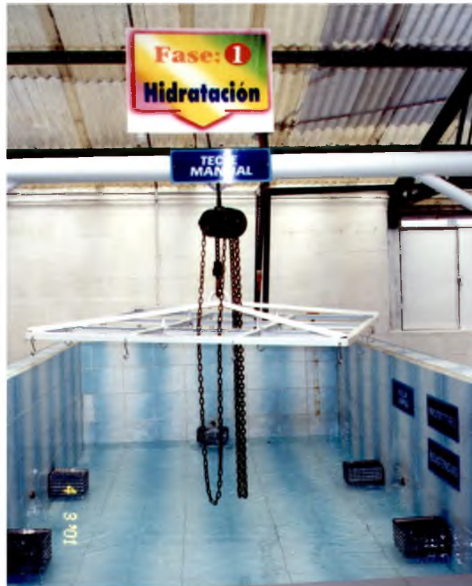
Foto 7A. Piscina de hidratación
