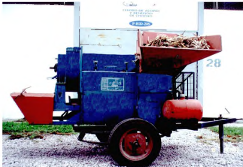
Foto 2. Trilladora mecánica para chocho
