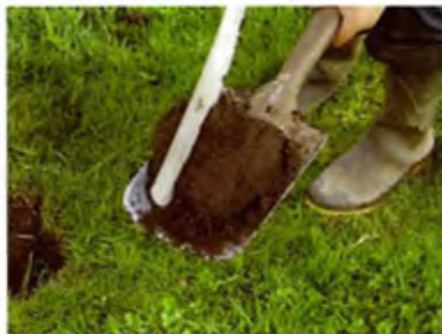
Fotografía 4. Corte de los extremos de la porción de suelo, dejando un bloque de 5 cm.
