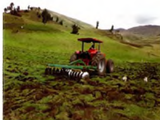
Fotografía 7. Preparación mecanizada de suelo empleando rastra de discos
