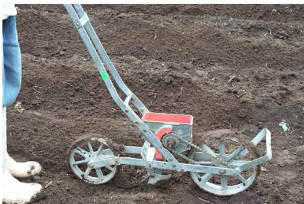
Fotografía 69. Máquina sembradora de amaranto. Para su buen funcionamiento el suelo debe estar bien preparado y con poca humedad.
