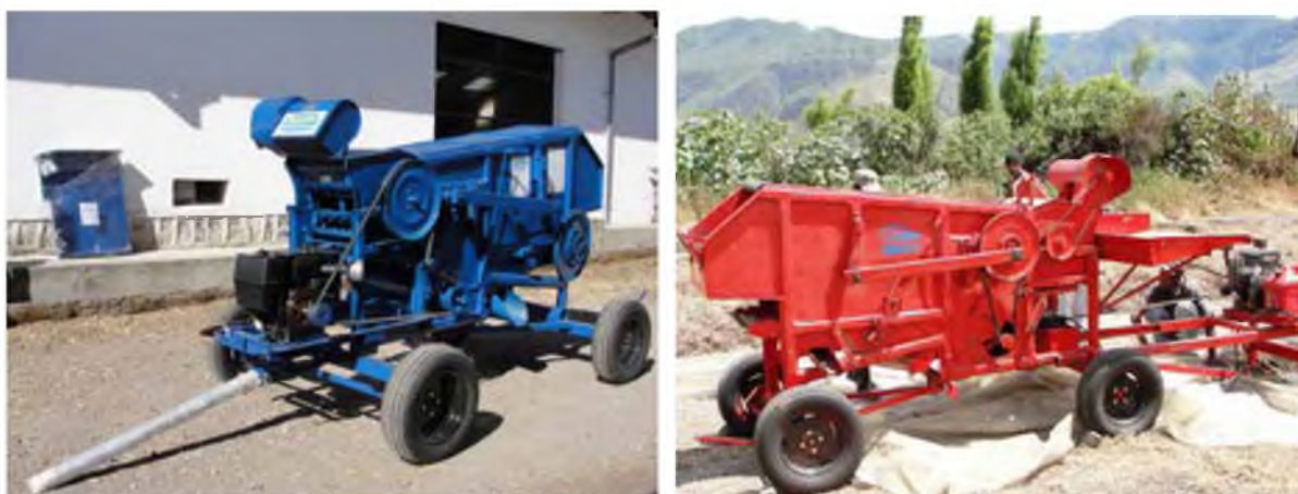
Fotografías 78. Modelos de trilladora de granos andinos y cereales que trillan ataco.
