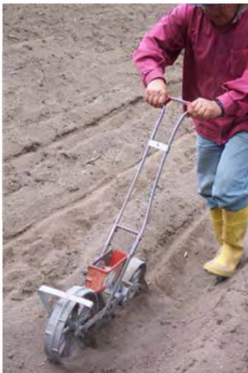
Fotografía 6. Sembradora mecánica con dosificador de alvéolos, ubica dos semillas cada 20 cm.
