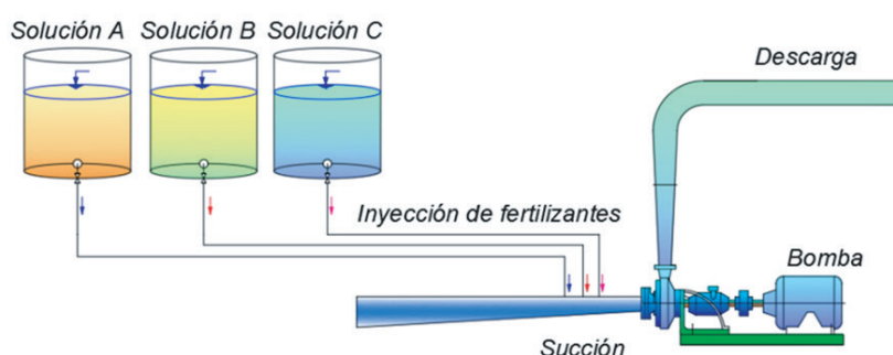
Figura 30. Inyección en la succión de una bomba.
