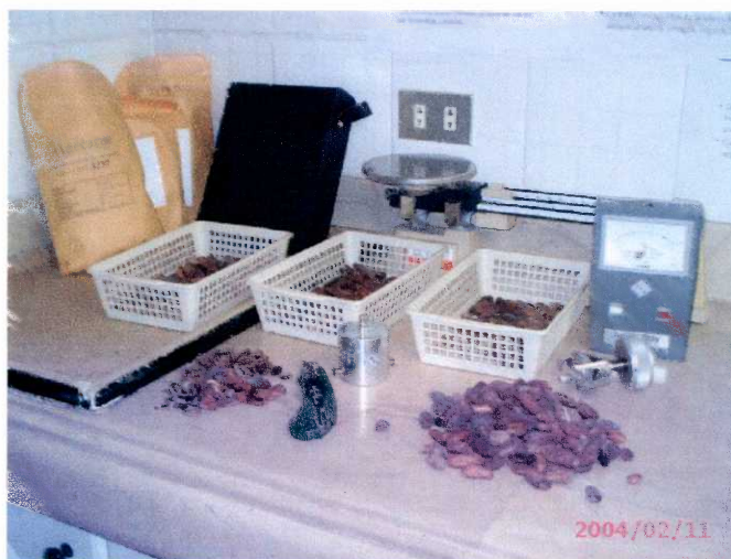
Ilustración 6. Equipos y suministros utilizados en la prueba macroscópica o prueba de corte.
