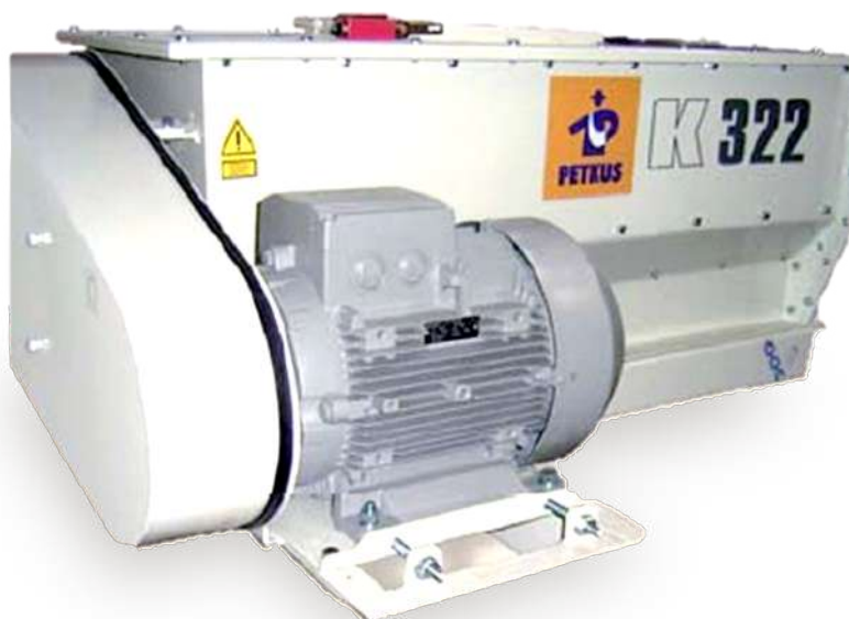
Figura 23. Desbarbador de semillas Petkus modelo K321 / K322. Catálogo, interempresas PETKUS, 2025.
