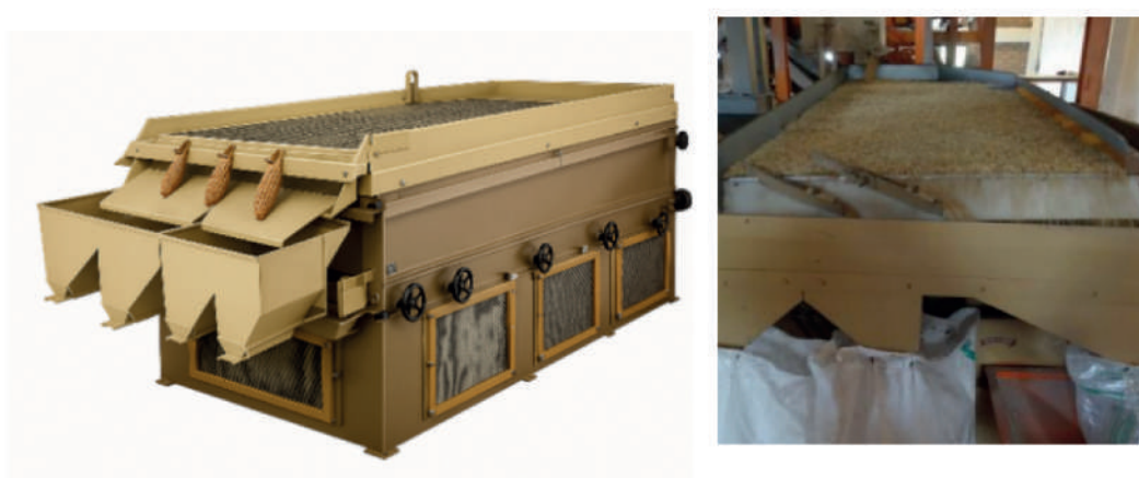
Figura 29. Mesa de gravedad o mesa densimétrica, INIAP-EESC. 2025.
