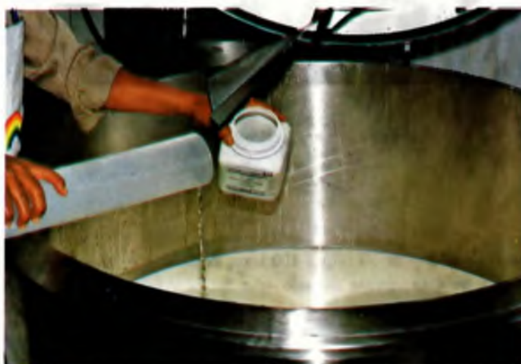
Figura 3. Adición de cloruro de calcio
