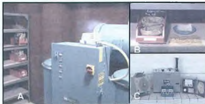
Figura 44 . A. Cuarto de secamiento de semillas del INIAP (21°C y 40 % HR), con su equipo de deshumidificación. B. Semillas en proceso de secado, en el cuarto de secamiento. C. Varios aparatos para determinación de humedad interna de las semillas. INIAP, 2008.
