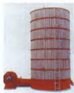
Figura 27. Sistema de distribución de aire por ducto central en secador estacionario tipo silo. (Peske y Villela, 2000).
