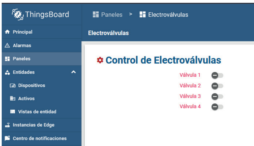
Figura 6. Interface de control de las electroválvulas.
