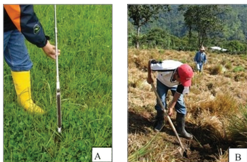
Figura 53. A: Muestreo de suelo con barreno. B: Muestreo con pala de desfonde
