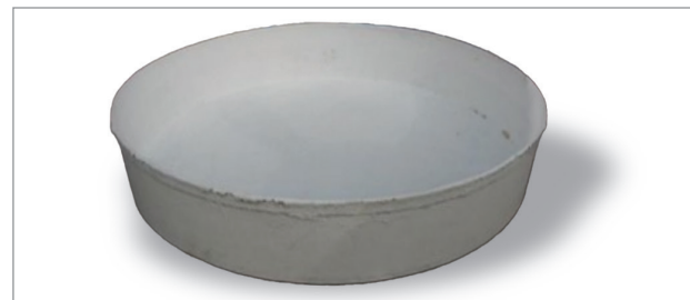
Figura 57. Bandeja "Clase A" para medir evaporación
