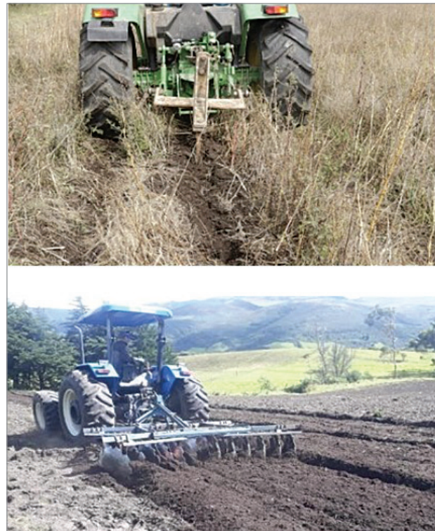
Figura 40. Rastra de disco durante la preparación del suelo
