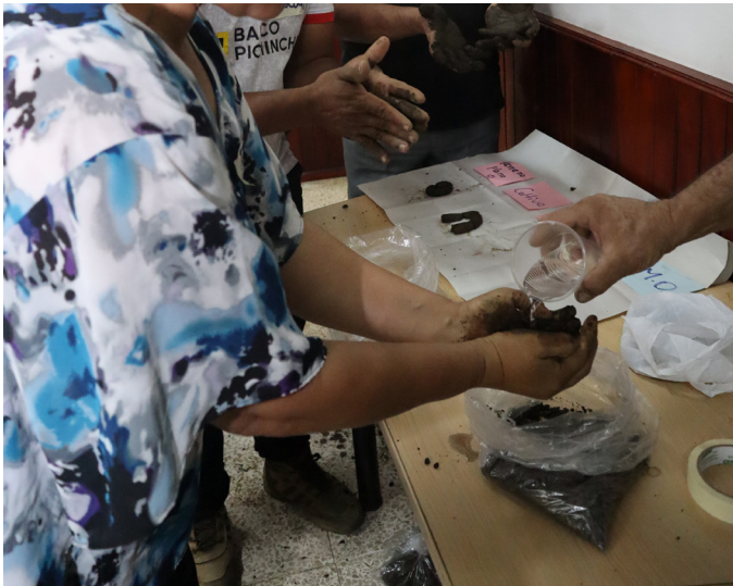
Adición de agua para moldear la muestra de suelo
