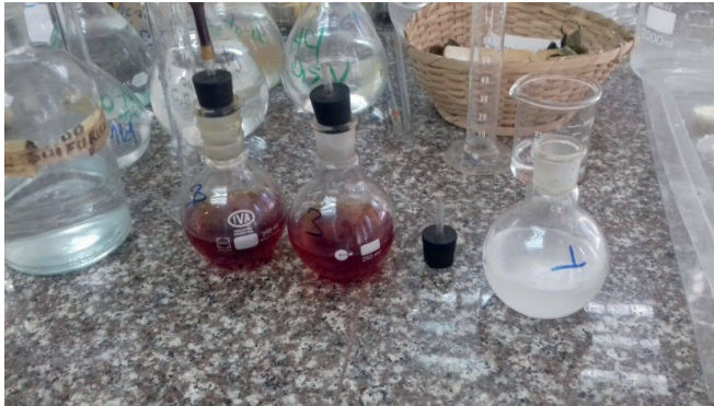
Figura 20. Determinación de índice de iodo.
