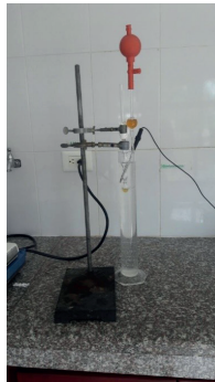
Figura 21. Determinación de viscosidad cinemática mediante viscosímetro Cannon-Fenske.
