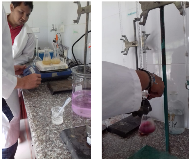
Figura 17. Ensayo de índice de acidez.
