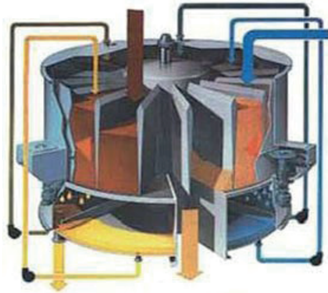
Figura 12. Equipo de extracción química de aceite de piñón de industria tipo Rotocel 1 .
