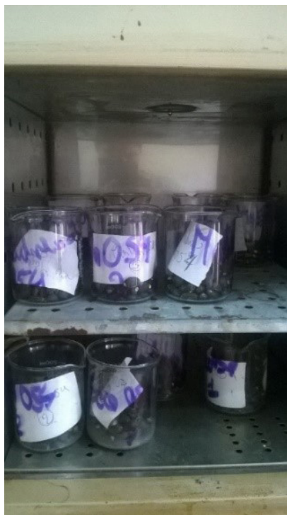
Figura 15. Determinación de humedad por el método de la estufa.
