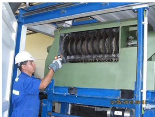
Figura 9. Máquina extractora continua de aceite de piñón.
