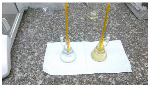
Figura 19. Determinación de densidad relativa mediante el método por Picnómetro.
