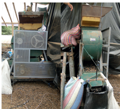
Figura 4. Equipo para el descascarado de frutos secos de piñón.
