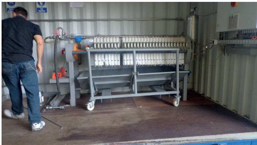
Figura 13. Filtro-prensa con sus respectivos platos de retención y mangueras de recirculación.
