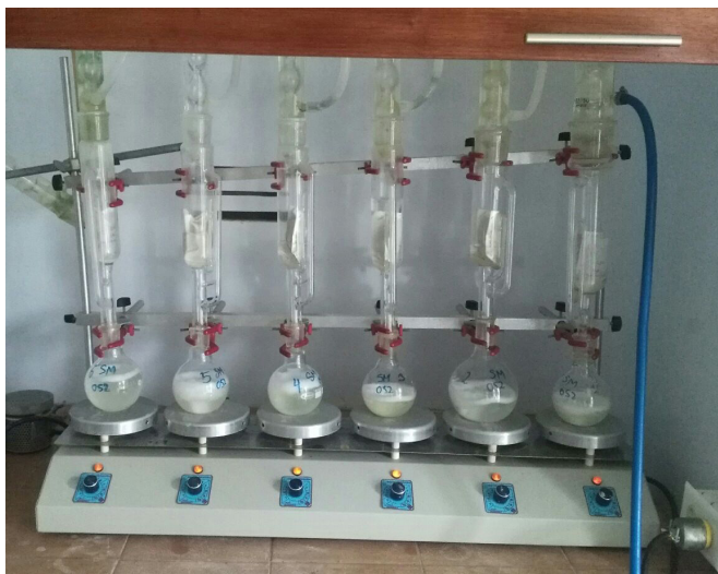
Figura 16. Equipo Soxhlet para determinar contenido de grasa cruda.
