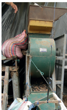
Figura 5. Equipo para el descascarado de semillas de piñón en estado maduro y sobremaduros.
