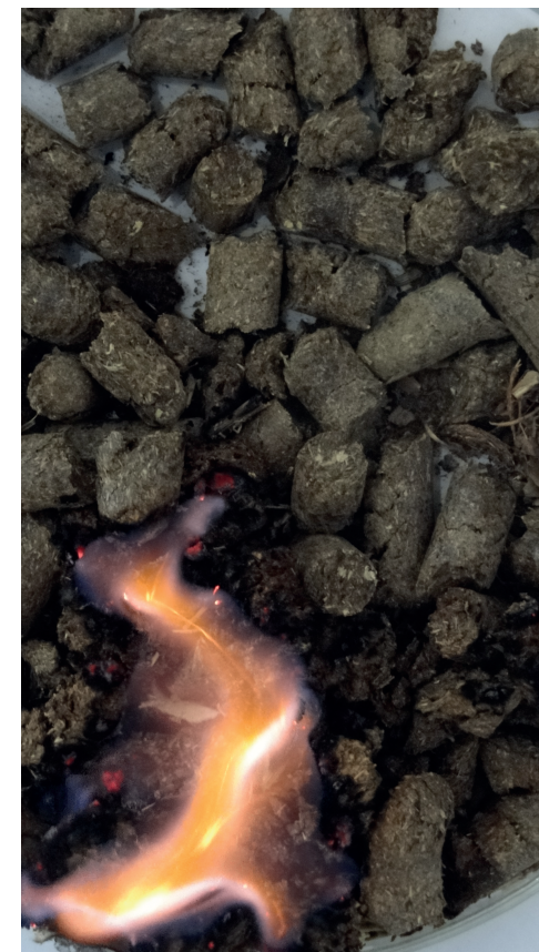
Imagen 2. Combustión de un pellet originado de una mezcla de residuos de paja de arroz y cáscara de piñón.
