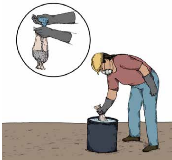
Figura 41. Forma de disolver el sulfato de cobre en un balde
