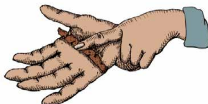
Figura 5. Análisis del tipo de suelo por el método de la cinta
