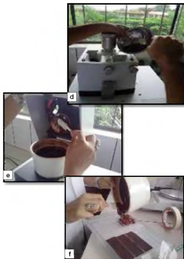
Foto 35. Molienda (d), conchado (e) y colocación en moldes (f) de la pasta de cacao.
