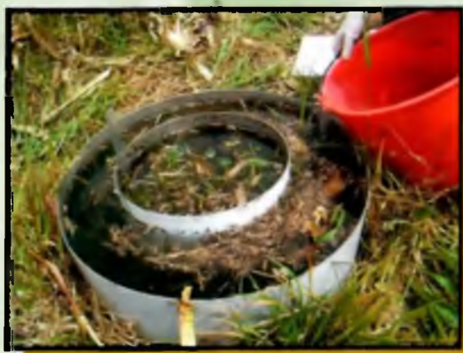
Foto 2. Prueba de infiltración con los cilindros en Labranza Cero. Provincia de Bolívar, 2003
