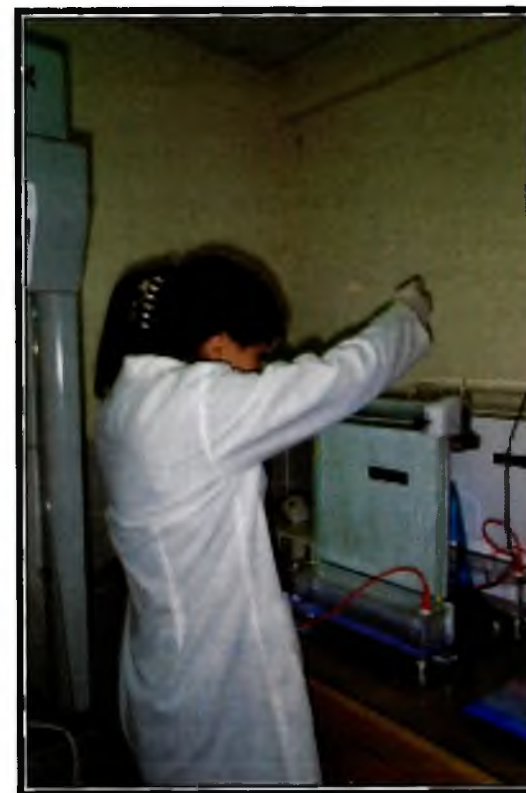
Foto 21: “Cargado del ADN” en los geles de acrilamida en la técnica de microsatélites. DENAREF-INIAP, 2003
