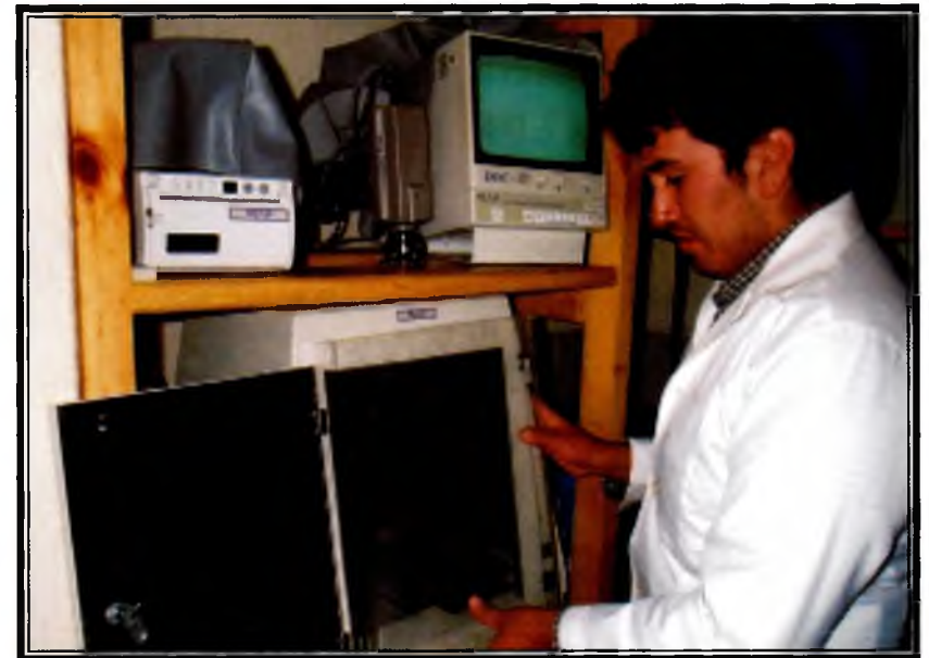
Foto 20: Fotodocumentación de los geles de agarosa, en la técnica RAPD, después de realizada la electroforesis. DENAREF-INIAP, 2002
