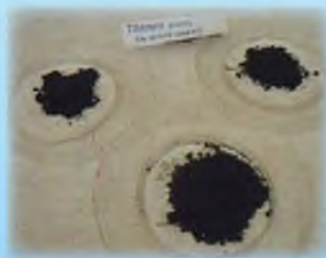
Figura 4. Extracción de NEPs de suelo con el uso de trampas White.
