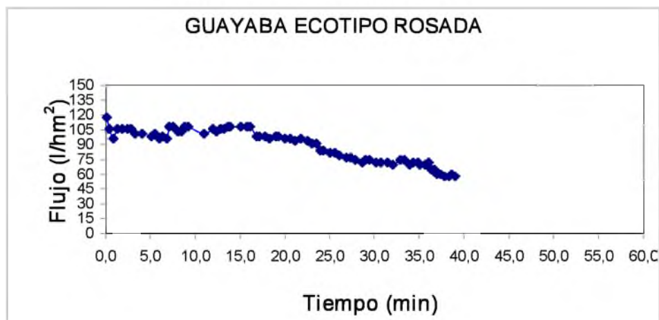
Figura 18. Variación del flujo del permeado en función del tiempo para el jugo de guayaba ecotipo Pulpa Rosada.
