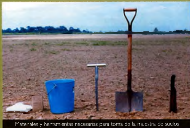
Materiales y herramientas necesarias para toma de la muestra de suelos
