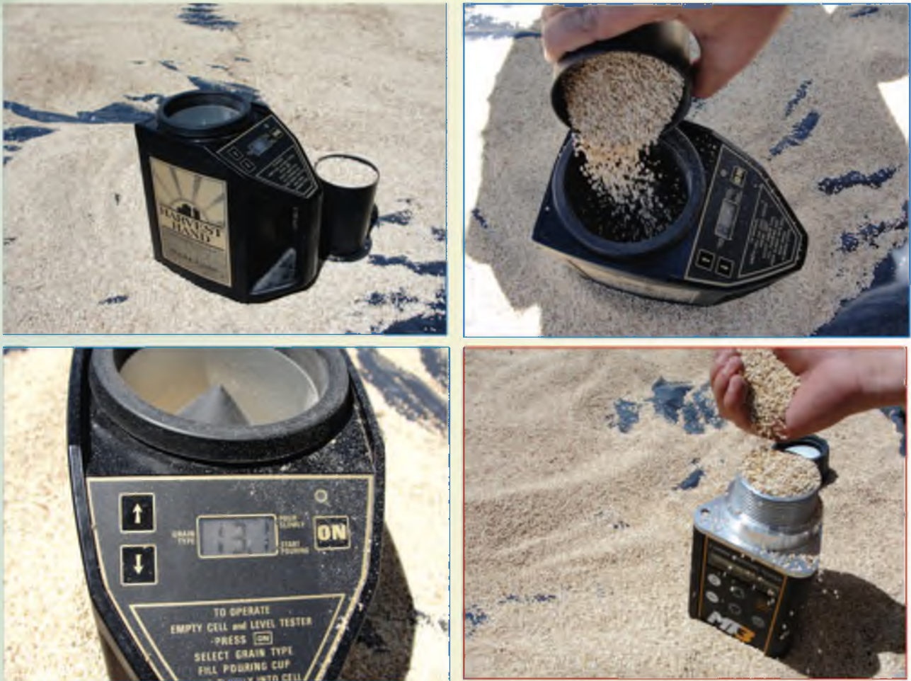
Foto 46. Medidores digitales que pueden estimar la humedad en granos andinos.
