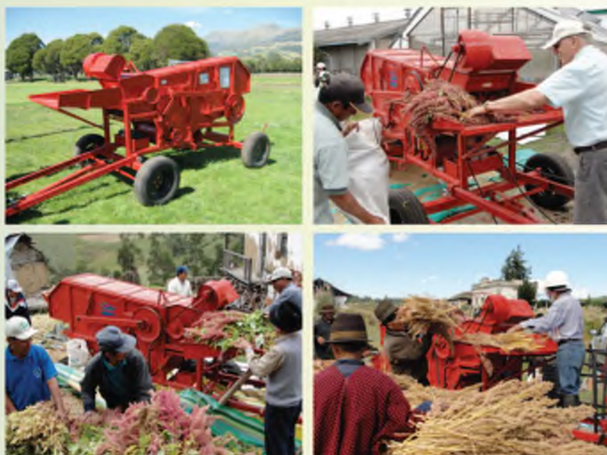
Foto 44. Trilladora mecánica para quinua y amaranto. Trilla 6 quintales por hora.
