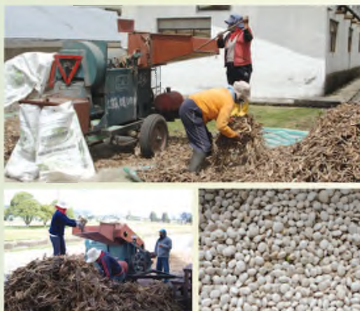
Foto 43. Trilladora mecánica para chocho. Trilla 8 qq por hora.
