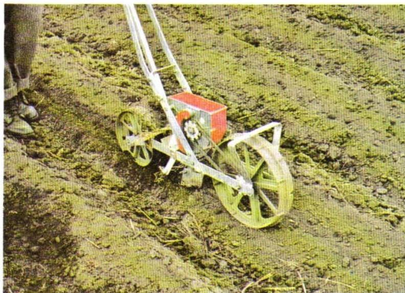
Figura 4. Siembra de amaranto, utilizando la sembradora de tracción manual (Prototipo INIAP).
