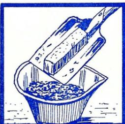
FIGURA No. 11.- Deposite la tajada (submuestra) en el balde.
