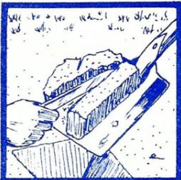
FIGURA No. 10.- Con un cuchillo o machete quite los bordes, dejando una tajada de cinco centímetros de ancho.
