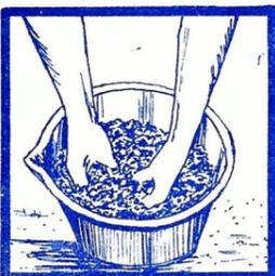
FIGURA No. 12.- Mezcle bien en el balde limpio las 15 a 20 submuestras así obtenidas.
