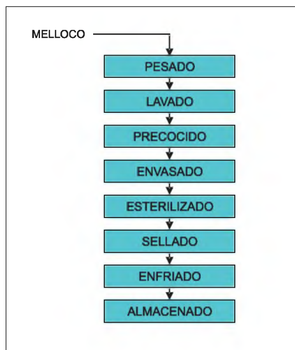
Figura 5.5. Diagrama de flujo para la elaboración de melloco en conserva.
