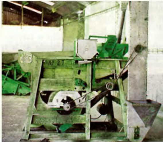
FOTO 11. Pequeña maquinaria aire-zaranda beneficiadora de semillas.
