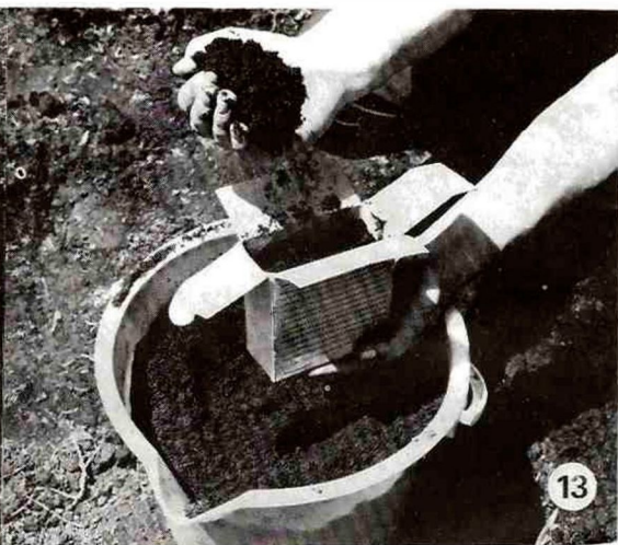
FIGURA 13.- Para enviar al laboratorio tome del balde una porción de aproximadamente dos libras.
