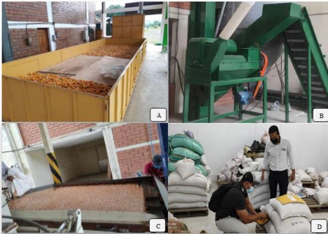
Figura 3. Reducción de humedad de mazorcas en secadora (A); desgrane de mazorca (B); clasificación y saneamiento de semilla en mesa densimétrica (C); semilla almacenada en cuarto frío (D).
